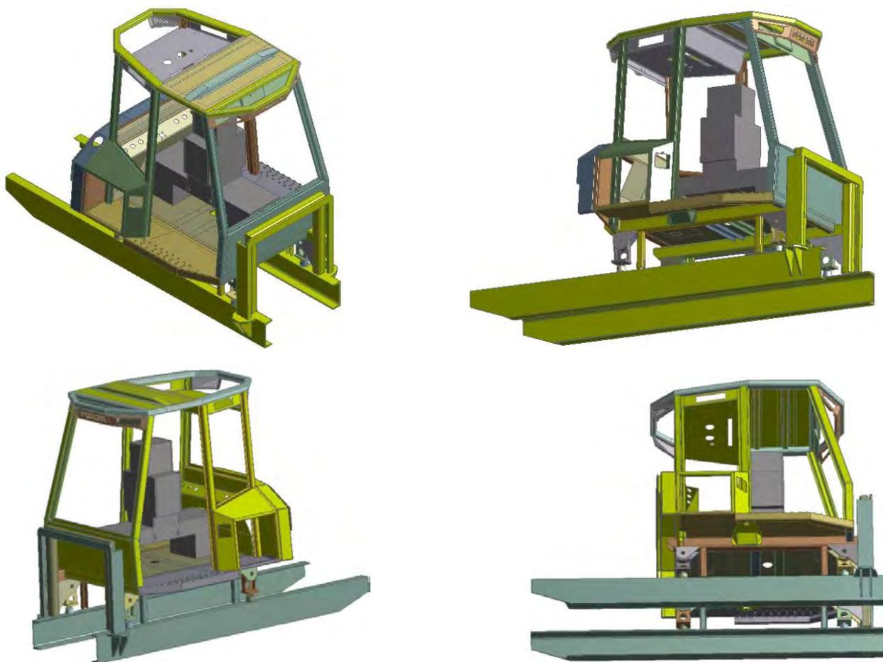
**ISO 8083:2006 (FOPS, Protección contra caída de objetos),** elementos de la cabina ensayados.
