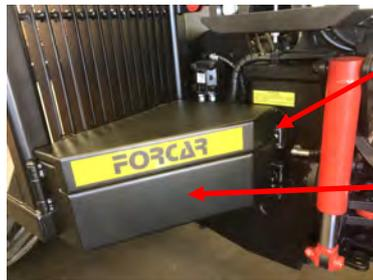
Escotilla de Acceso (con cierre en Inox con llave) al **mando hidráulico para la elevación/descenso de la cabina.**
