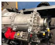
Detalle del Convertidor de Par con Programa de Retención de Velocidad y Ayuda de arranque en pendientes.
