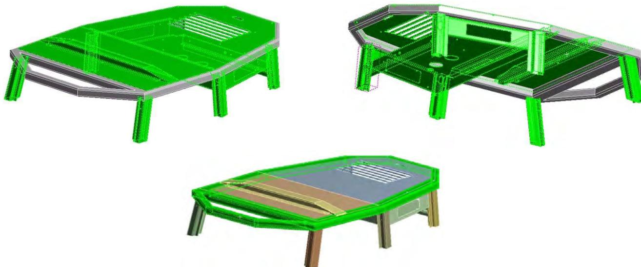
**ISO 8084:2003 (OPS, Protección contra penetración de objetos),** elementos de la cabina ensayados.
