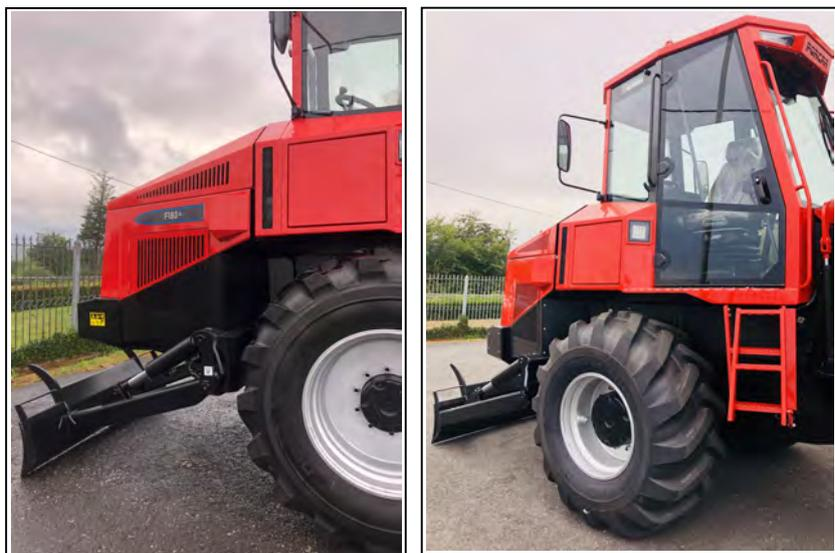
También destacar que la cuchilla es independiente de las protecciones del motor. Evitando que entren piedras, ramas o cualquier objeto externo que pueda dañar el motor diésel.
